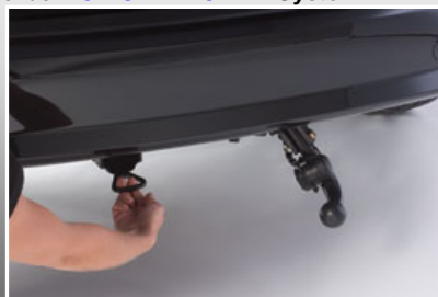
Abb.: Auslöse- und Schwenkmechanismus bei dem ORIS-MATIC M11-System
